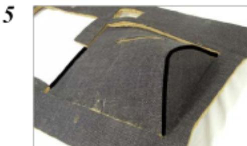
Die Teile Nr. 3 und Nr. 5 werden ebenfalls mit einer 10 mm Naht an das Teil Nr. 1 angenäht, wie im Bild gezeigt.
