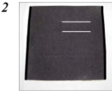
Befestigen Sie zunächst das Vinyl (Nr. 3) an den Markierungen an Teil Nr. 3. Für Baujahr 1970-1973 (Fahrzeuge mit Einspritzanlage) müssen zwei Schlitze geschnitten entlang der markierten Linien an der oberen Ecke geschnitten werden.
